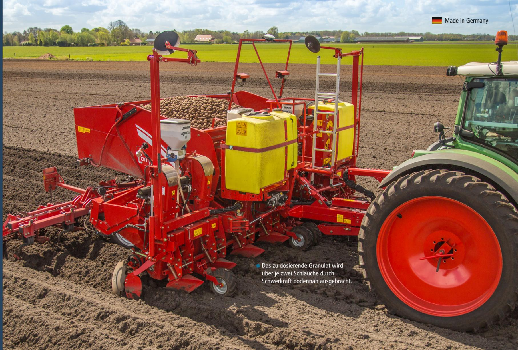
Das zu dosierende Granulat wird über je zwei Schläuche durch Schwerkraft bodennah ausgebracht.
